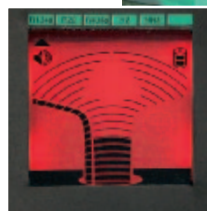
Schleppzeiger zeigt Maximalleckagen an
